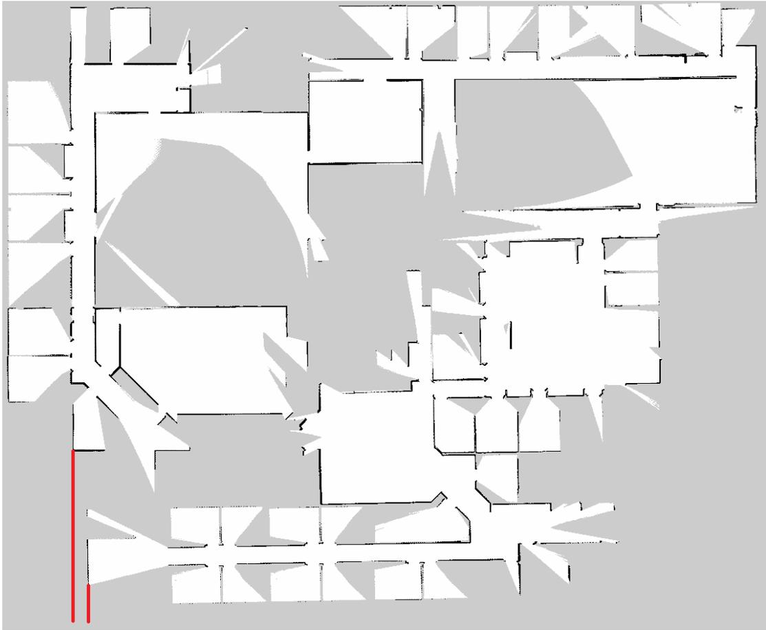
**Abbildung 3.9:** Ergebnis Jackal Cartographer - Willowgarage Route 2 mit vermiedenen Kreisschlüssen: Die beiden roten Linien verlängern dieselbe Wand, die am Anfang und Ende der Route gescannt wurde. Es ist eine Abweichung erkennbar.
