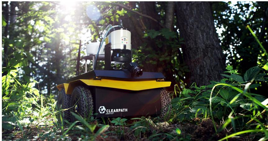
Abbildung 3.4: Jackal Roboterplattform von Clearpath Robotics<sup>6</sup>
