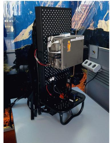
**Fig. 3.1:** Ein Rucksack, der mit mehreren Sensoren für den Cartographer ausgestattet ist.<sup>1</sup>
